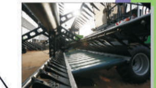
Полотенные транспортеры могут находиться в 3-х положениях: для формирования валка по центру, вправо или влево
